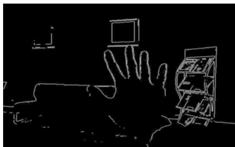
图3 利用 Sobel 算子检测到的边缘
