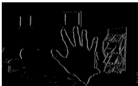
图4 利用图像 RGB 分量变化趋势检测到的边缘 互时,手的位置位于摄像头拍摄到的所有场景物体
